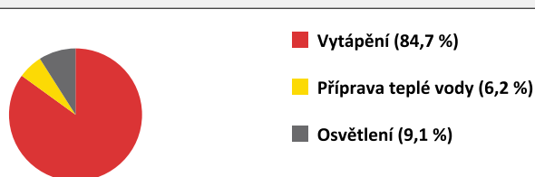
Podíl primární energie z neobnovitelných zdrojů dle účelu
