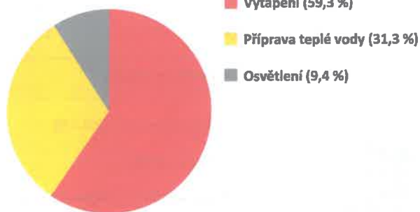
Podíl primární energie z neobnovitelných zdrojů dle účelu
