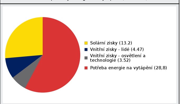
Bilance potřeby energie na vytápění (MWh/rok)
