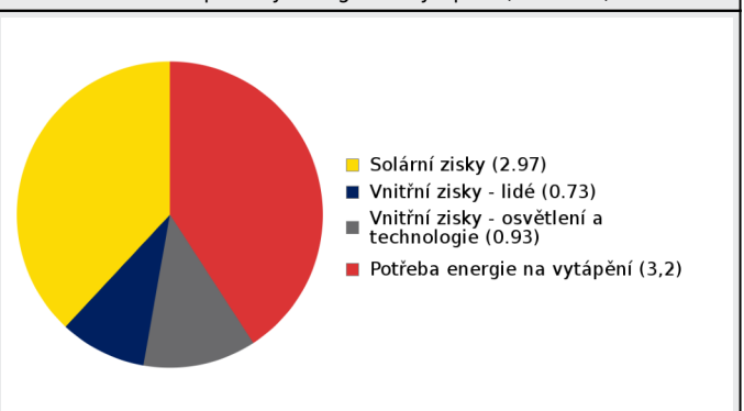
Bilance potřeby energie na vytápění (MWh/rok)
