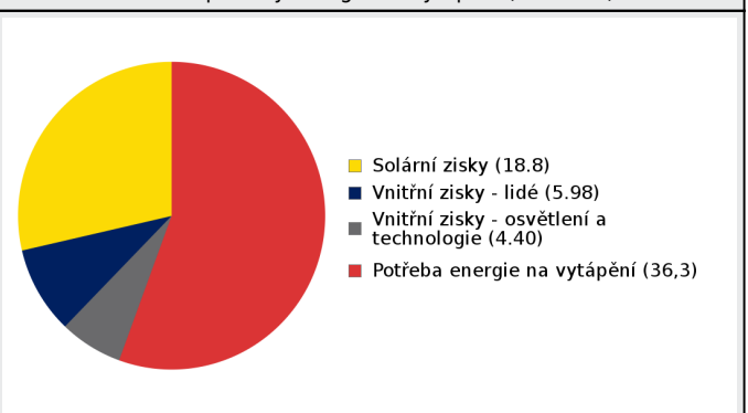
Bilance potřeby energie na vytápění (MWh/rok)
