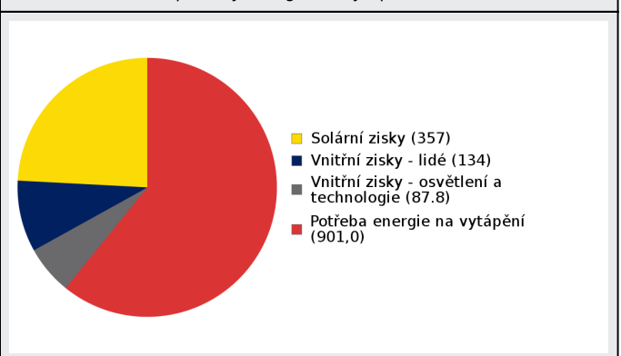
Bilance potřeby energie na vytápění (MWh/rok)
